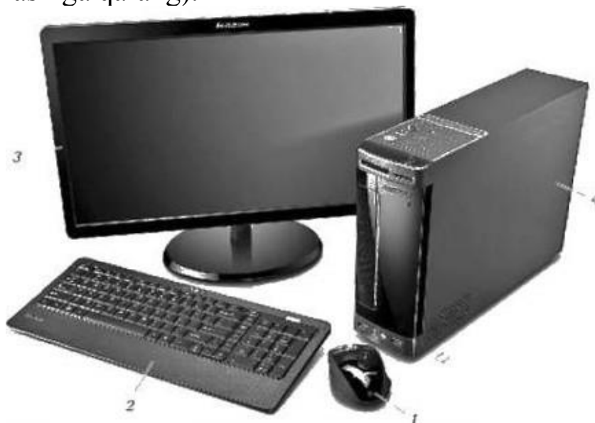
2.5-rasm. Shaxsiy kompyuter (1 - sichqoncha; 2 - klaviatura; 3 - monitor; 4 - tizimli blok).
