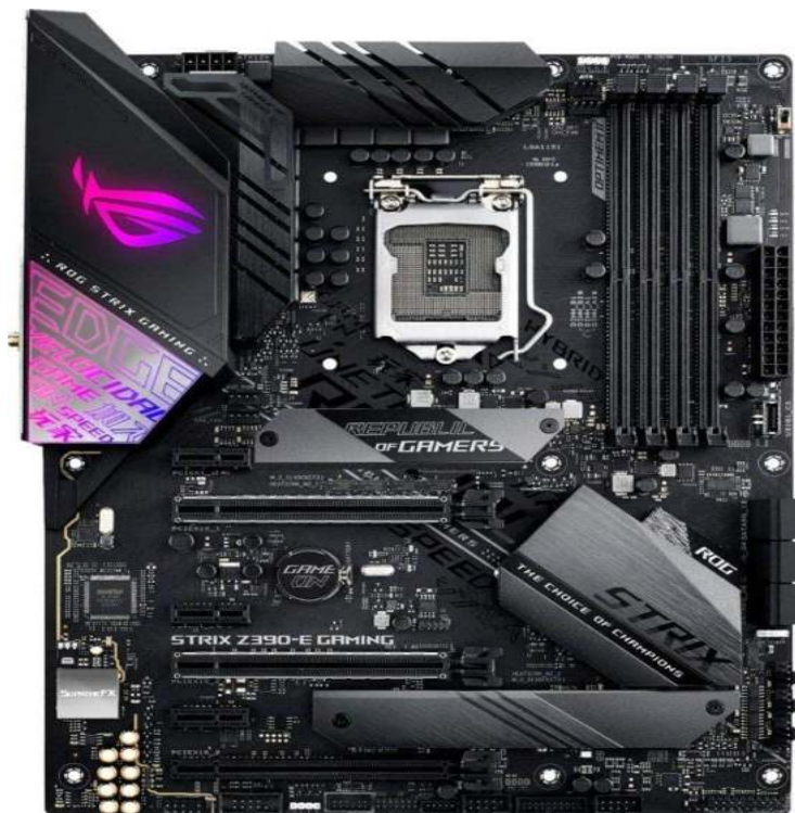
2.8-rasm. ASUS ROG Strix Z390-E LGA1151 o`yin uchun ona plata (Intel 8- 9-avlodlari) ATX DDR4 DP HDMI M.2 USB 3.1 Gen2 802.11AC Wi-Fi.
